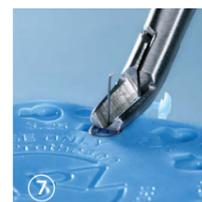
**Section de la tige :** La micro-pince coupante (RÉF 8000 171) permet de sectionner la tige de projection aisément avec une grande précision.
