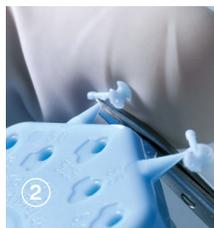
**Abschneiden des Sizers:** Mit der feinen Mikroschere (REF 8000 172) kann der Sizer in unmittelbarer Nähe des Schafts von der Sizer Disk entfernt werden.
