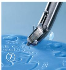
**Entfernen des Schafts:** Der überstehende Schaft wird mit dem Schneidezängchen (REF 8000 171) entfernt. Er lässt sich damit einfach und sehr präzise durchtrennen.
